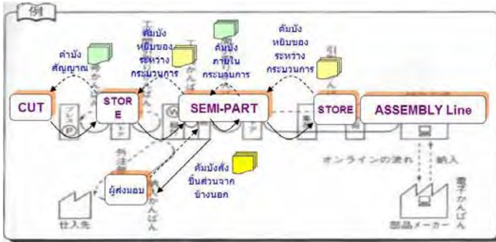
รูป 3 (ล่าง) แสดงการใช้งานคัมบังประเภทต่างๆภายในระบบการผลิตแบบโตโยต้า
